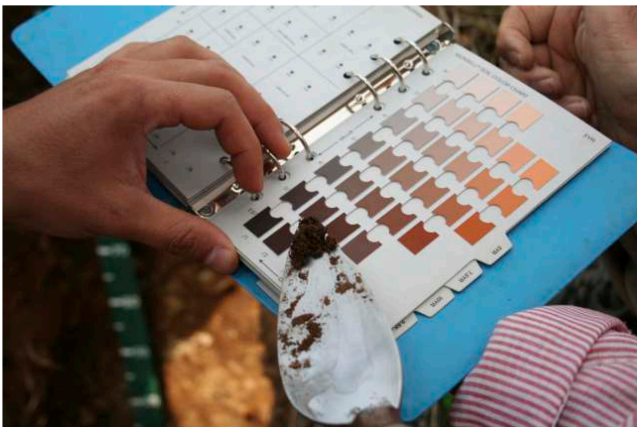
Fig. 4 - Identificazione del colore di uno strato utilizzando il sistema Munsell, al fine di individuare una delle tante caratteristiche del suolo utili per la sua classificazione. (foto Federico Balzan)
