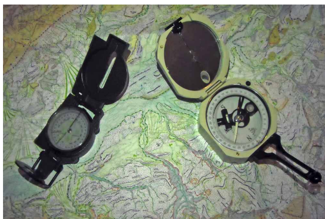
Fig. 1 - Una bussola da geologo a destra, una bussola topografica a sinistra.
