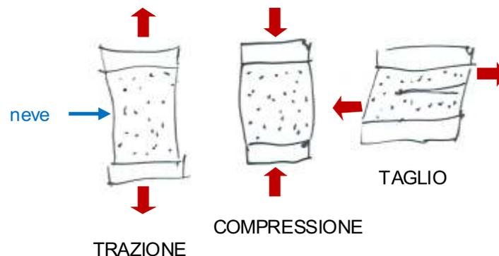
Fig. 6 - I tre principali tipi di sollecitazione che si possono applicare al manto nevoso e relative deformazioni.
