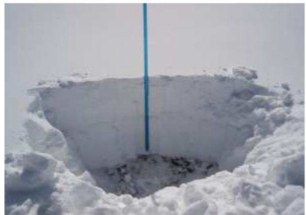
Fig. 2 e Fig. 3 - Identificazione degli strati attraverso il colore, la durezza, l'umidità, la densità e la temperatura nell'esecuzione di un profilo del manto nevoso. Col dei Baldi (BL) e monte Baldo (VR).
